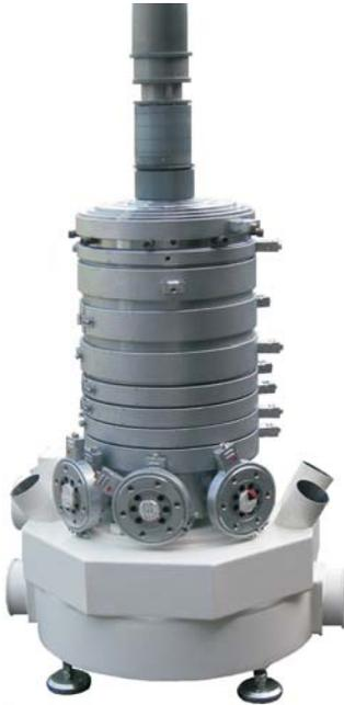
ETA-Blasfolienwerkzeuge werden für die Produktion unterschiedlichster ein- und mehrschichtiger Folien eingesetzt. Stationär und rotierend mit bis zu 9 Schichten. Düsendurchmesser 4 - 800 mm.
