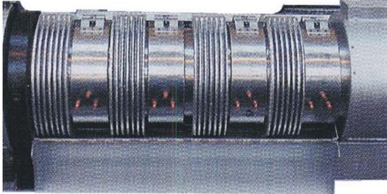
**Bild 3:** Heiz-/Kühl-Einheit mit gerippten Aluminium-Ringen (Reifenhäuser, Troisdorf)
