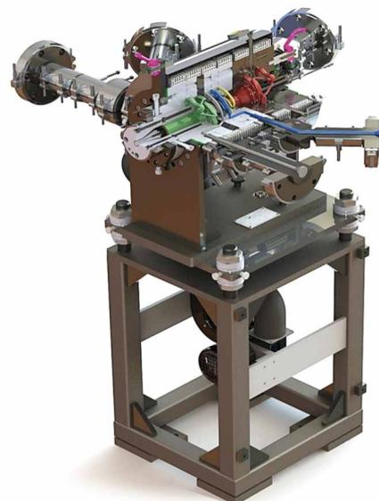
ETA 5-Schicht Coextrusionswerkzeug.
